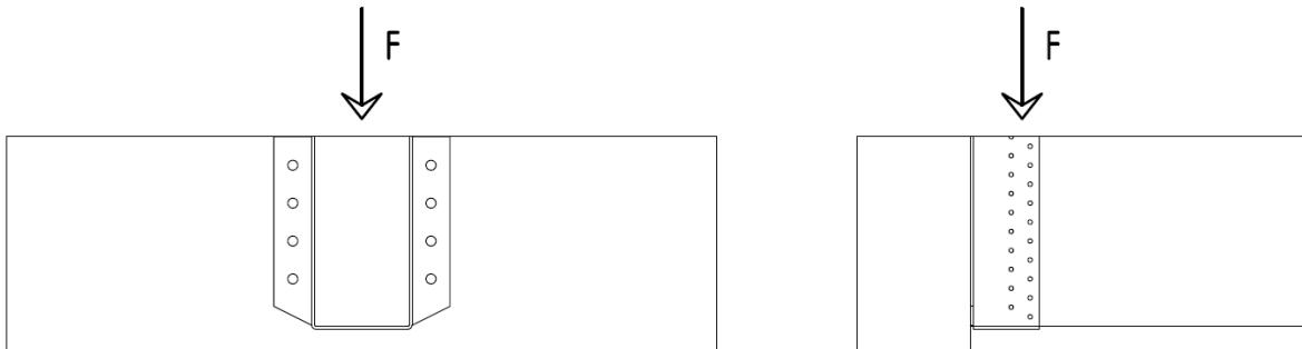
Obr. 1: Směr namáhání ve vztahu ke spojovaným prvkům – trimmer connection
