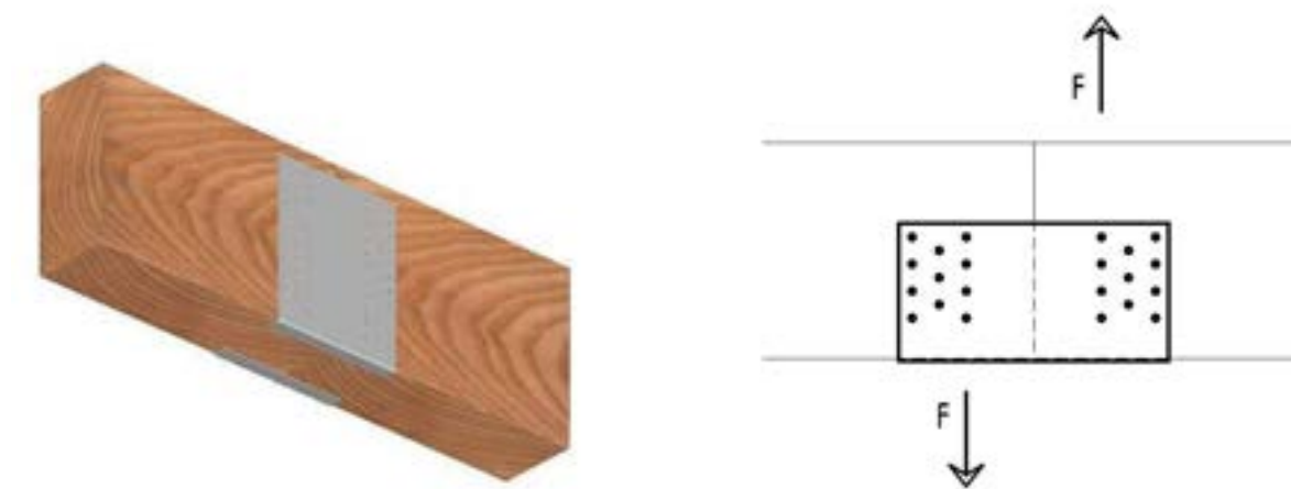
Obr. 1: Směr namáhání 2 ve vztahu ke spojovaným prvkům
